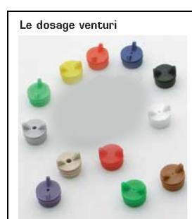
Le choix du dosage venturi se fait en modifiant la dimension de la section d'aspiration du produit. Cette opération est effectuée au moyen de gicleurs de couleur calibrés dont la taille de l'orifice varie.
